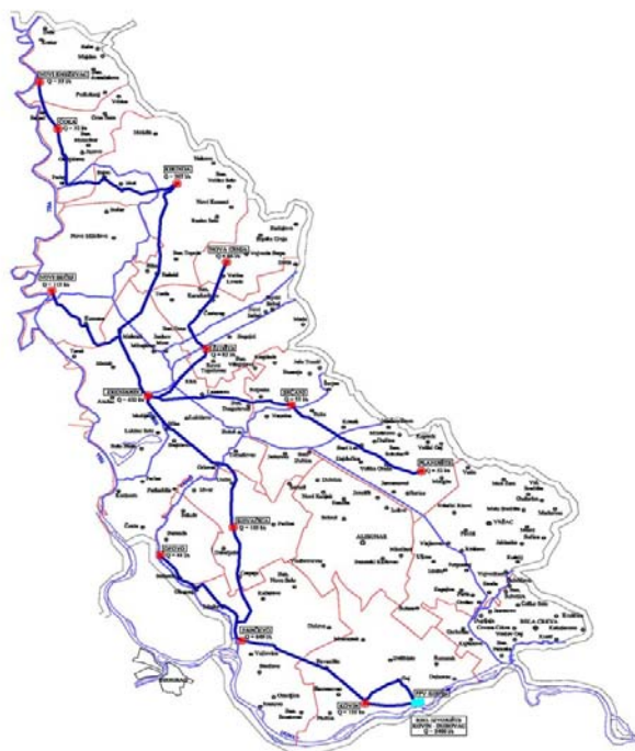
Слика 4. Шематски приказ регионалног водоводног система Дубовац-Зрењанин-Киkinда (Институт за водопривреду Ј.Черни, Београд, 2006)
